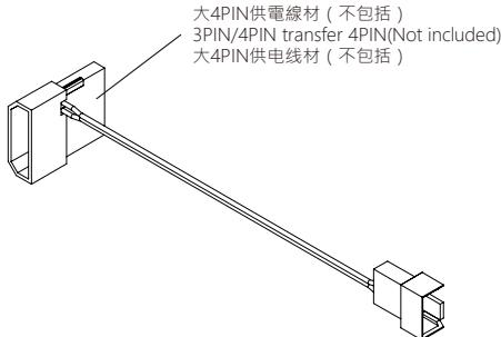
S1馬達除了可由主機板供電外，亦可透過轉接線由電源供應器直接供電。
