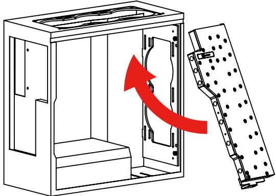
水道板傾斜放入機殼內部，然後扶正
