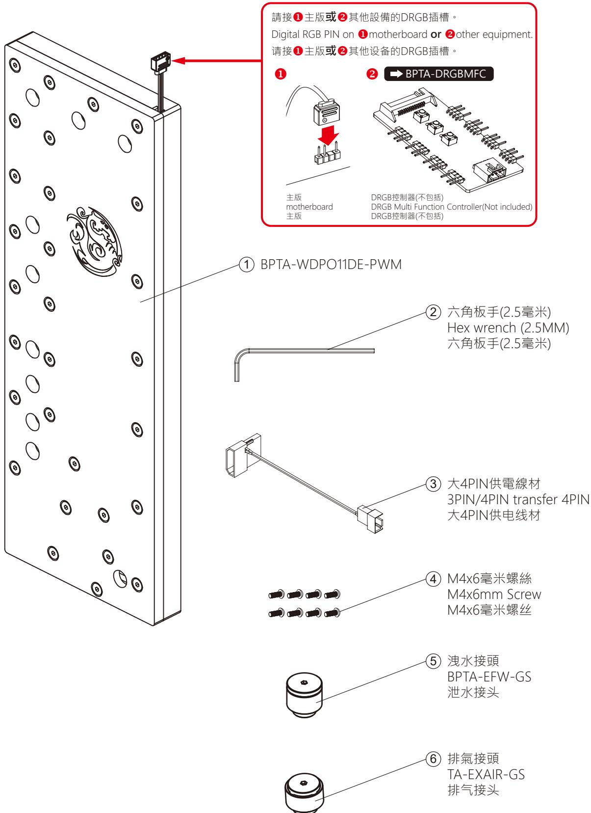
注意：跑水前，請先確認所有零件已安裝在正確的位置上，在不開主機，單開水泵的情況下，進行24小時的跑水測試，確保無漏水情況後再開主機，避免發生漏水而導致電腦零件的損壞。
