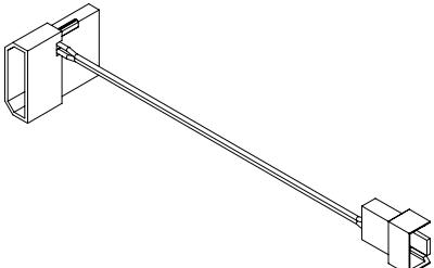
S1馬達除了可由主機板供電外，亦可透過轉接線由電源供應器直接供電。
