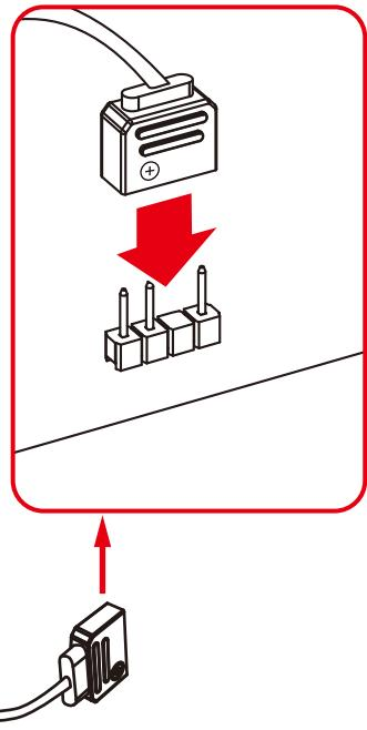
此DRGB控制器作用是擴展主板上不足的RGB接口，一個DRGB接口可分出八個，用於統一控制多個支援主板燈效的風扇和燈條等設備；同時，控制器具備自有的燈光效果，可透過控制器上的按鍵來切換。
