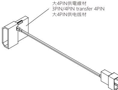
S1馬達除了可由主機板供電外，亦可透過轉接線由電源供應器直接供電。
