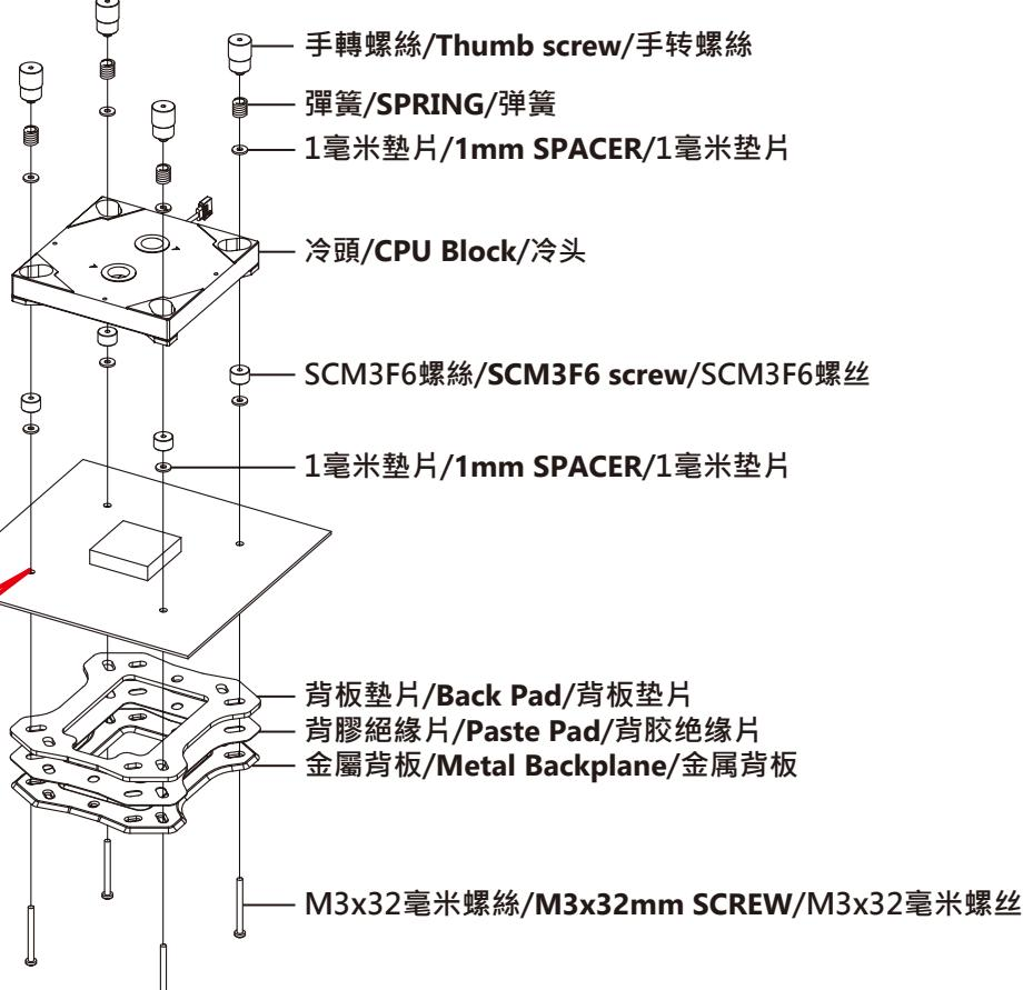
注意：跑水前，請先確認所有零件已安裝在正確的位置上，在不開主機，單開水泵的情況下，進行24小時的跑水測試，確保無漏水情況後再開主機，避免發生漏水而導致電腦零件的損壞。
