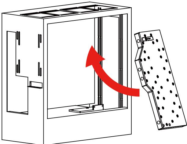
水道板傾斜放入機殼內部，然後扶正
