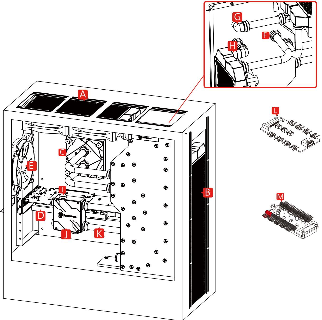
注意：跑水前，請先確認所有零件已安裝在正確的位置上，在不開主機，單開水泵的情況下，進行24小時的跑水測試，確保無漏水情況後再開主機，避免發生漏水而導致電腦零件的損壞。
