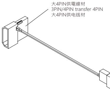
S1馬達除了可由主機板供電外，亦可透過轉接線由電源供應器直接供電。
