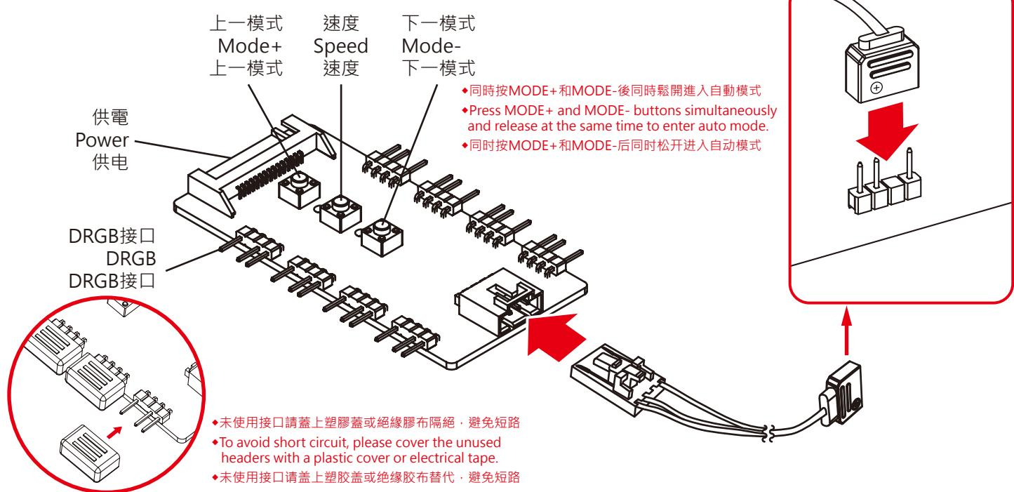
此DRGB控制器作用是擴展主板上不足的RGB接口，一個DRGB接口可分出八個，用於統一控制多個支援主板燈效的風扇和燈條等設備；同時，控制器具備自有的燈光效果，可透過控制器上的按鍵來切換。
