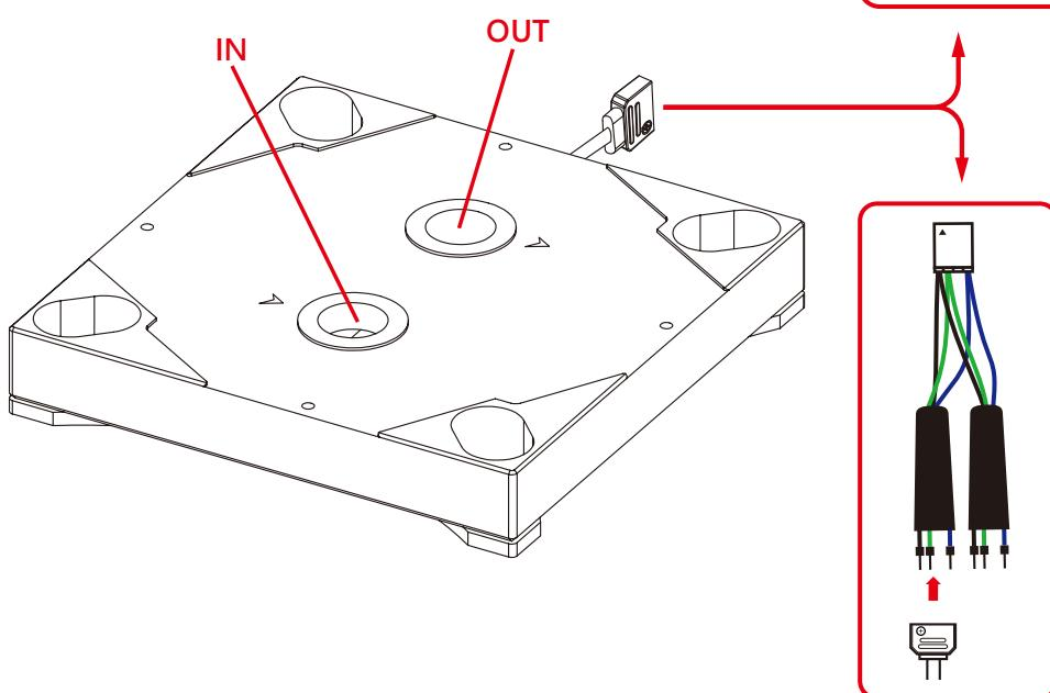
**!** 注意：跑水前，請先確認所有零件已安裝在正確的位置上，在不開主機，單開水泵的情況下，進行24小時的跑水測試。確保無漏水情況後再開主機，避免發生漏水而導致電腦零件的損壞。
